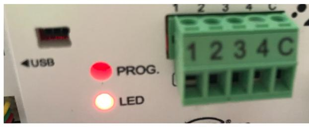
**Sugerencia:** Compruebe la conexión de la interfaz e inicie la programación. Si la programación falla, reinicie y vuelva a conectar el dispositivo con la interfaz. Verifique las credenciales del DoorBird.
