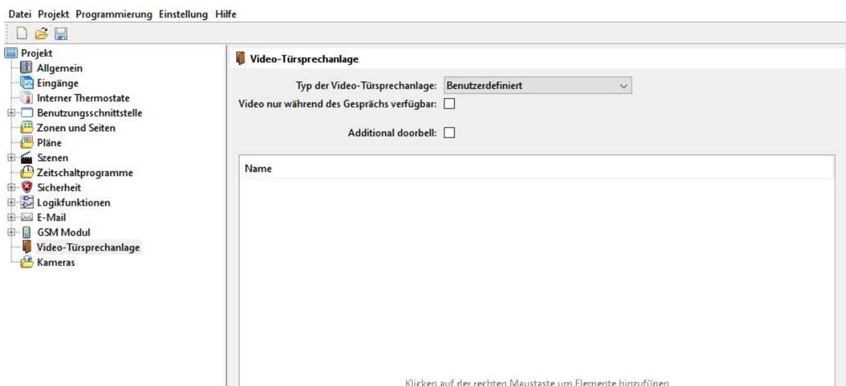
3. Wählen Sie aus dem Dropdown-Menü **„Typ der Video-Türsprechanlage“** den Eintrag **„Benutzerdefiniert“**.
