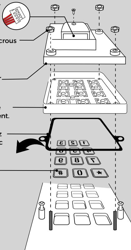
! Afin que la frappe soit souple sur le clavier, serrez les écrous de fixation fermement à la main, puis desserrez-les sur un demi-tour. Si une des touches ne s'enfonce pas correctement, c'est que l'écrou à proximité a été trop serré.
