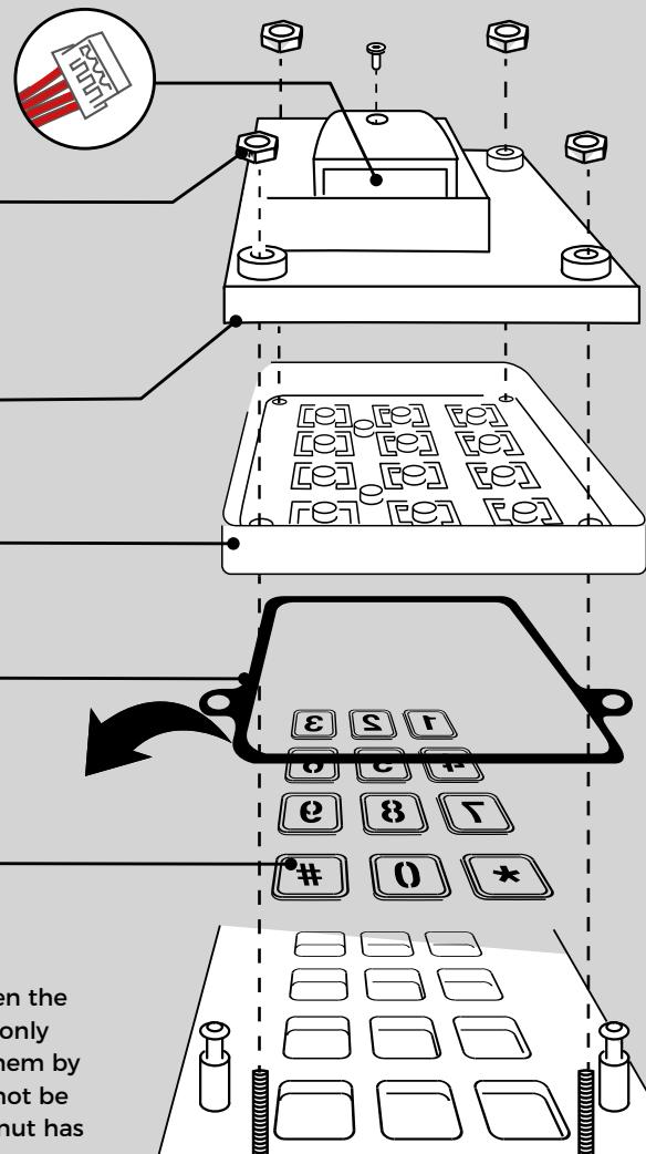
Entfernen Sie vor dem Austausch das Verbindungskabel vom Keypad.
