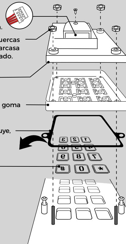
! Apretar las tuercas de fijación en el teclado a mano para que la presión de las teclas sea suave y, a continuación, aflojarlas media vuelta. Si una tecla no se presiona bien, significa que la tuerca adyacente se ha apretado demasiado.
